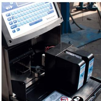
*Il sistema di gestione "intelligente" dei fluidi Smart Cartridge™ nel codificatore Videojet 1710*
